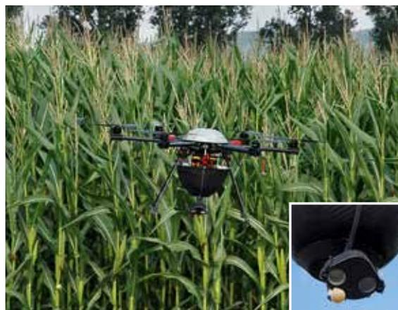
Ausbringung von Trichogrammakapseln mit einem GPS-gesteuerten Multikopter.
